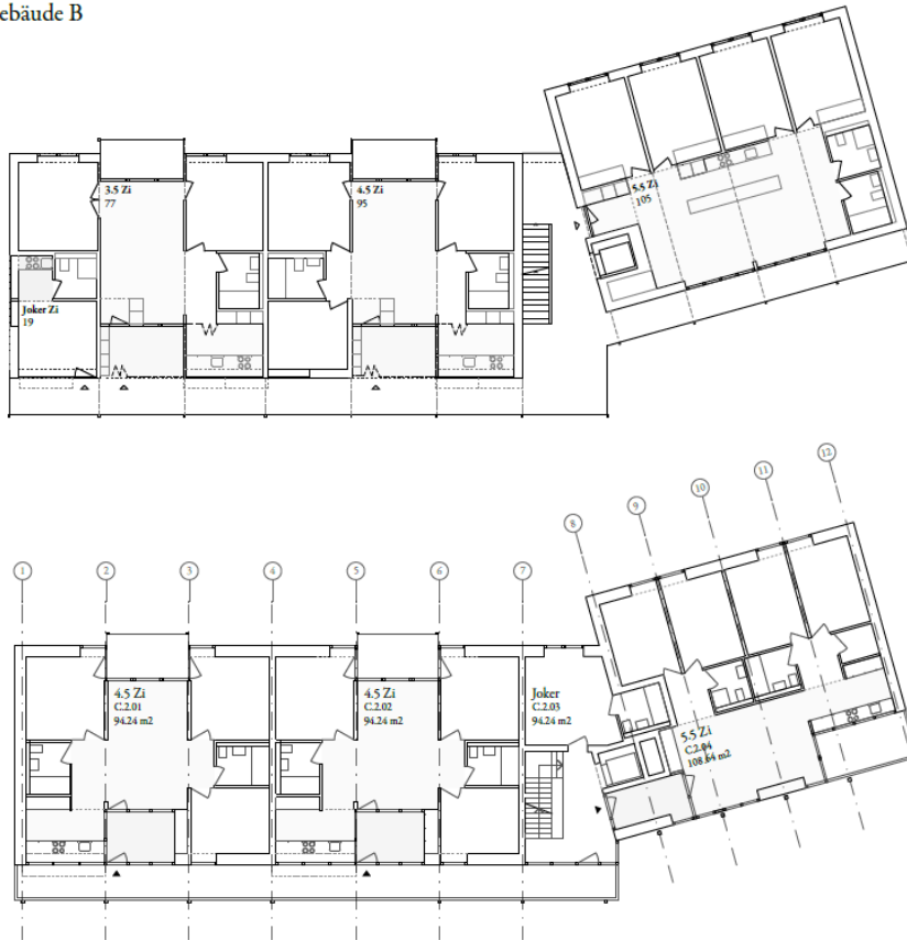
Abbildung 4: Beispiel Veränderung Treppenschliessung / Gebäudehülle Haus B
